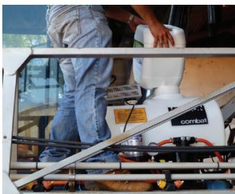
**5** Abasteça o tanque do Micron com o atrativo e inseticida, mantendo o agitador ligado por 20 a 30 minutos para que a mistura fique perfeito
