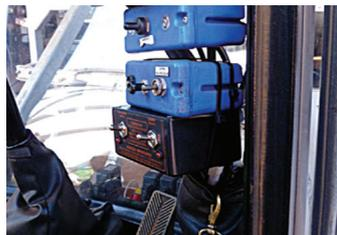
**2** Instalar o comando dentro da cabine, ao alcance do operador, e fazer a ligação entre o comando e o Micron, e entre o comando deste e a bateria
