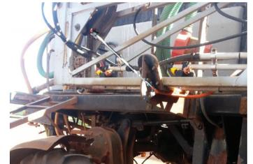
**4** Fixar haste com bico para que fique de altura de 50 a 100 cm do topo da planta, a 45 graus da horizontal. Em aplicações de baixa vazão, reduzir o ângulo em relação ao solo para aumentar a deposição da isca-tóxica nas folhas
